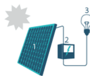
1. Zonnepaneel | 2. Omvormer | 3. Elektrische toestellen
